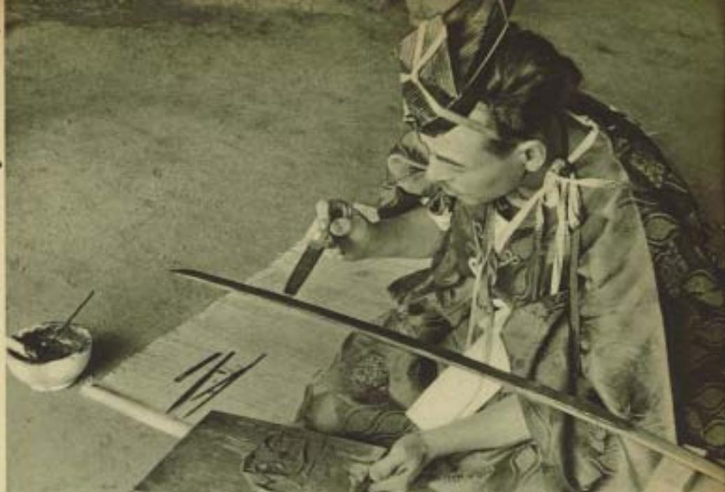
Per dare elasticità e splendore alla lama la si ricopre con un miscuglio di creta, terra per lucidare e carbone: con una nuova cottura la miscela si incorpora interamente con il metallo.
